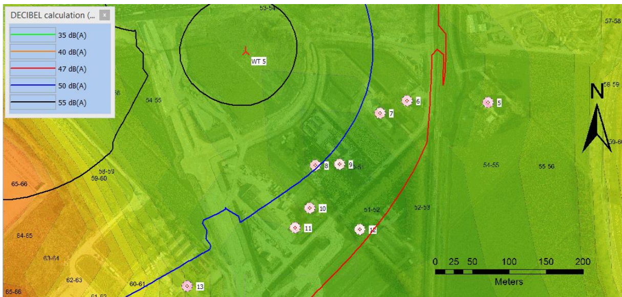
Figuur 5a: Berekende geluidscontouren voor aanvullende V100 2.2 MW @ 75 m (mode 2, SE bladen) i.c.m. industrielawaai met selectie van geluidsontvangers (Bron industrielawaai: ODMH)
